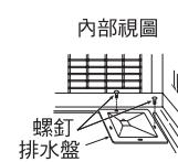
用兩個螺釘將排水盤安裝於機殼的右角。
